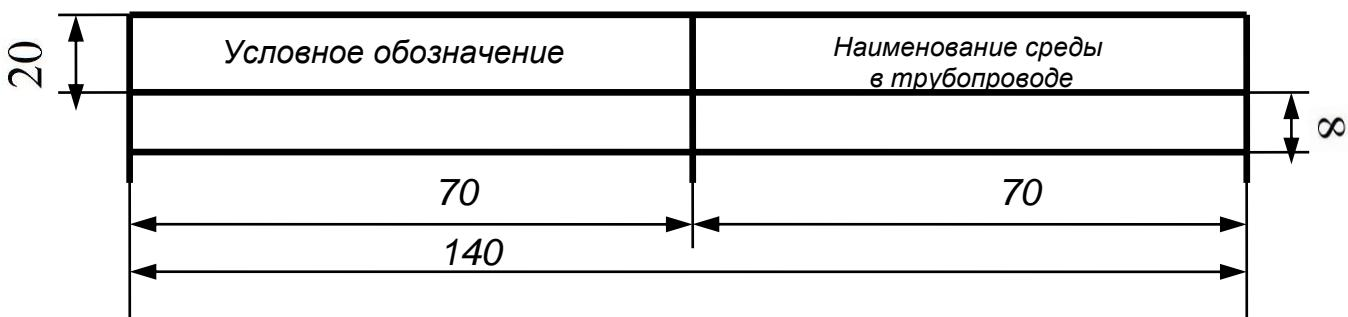
Рисунок К.1- Таблица веществ, транспортируемых по трубопроводам
